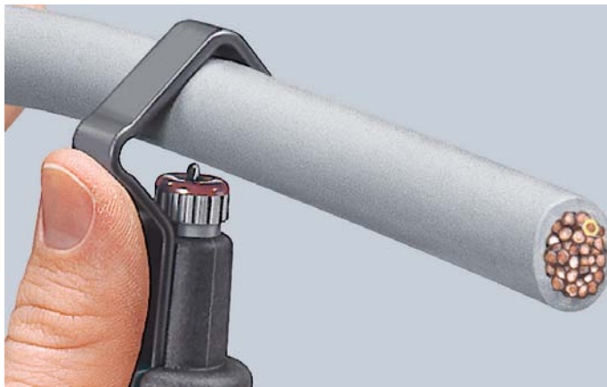
Nastavení nástroje pro obvodový řez
