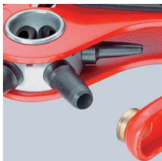
Jednotlivé střížníky je možné vyměňovat
