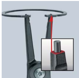
Pevné usazení kroužků: velké opěrné plochy a poloha hrotů zabraňují odskočení
