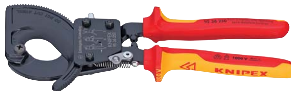
Princip rohatky se západkou a dvoustupňový pohon ozubeným věncem pro stříhání šetřící síly
