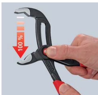
Stisknout knoflík – kompletně otevřít kleště
