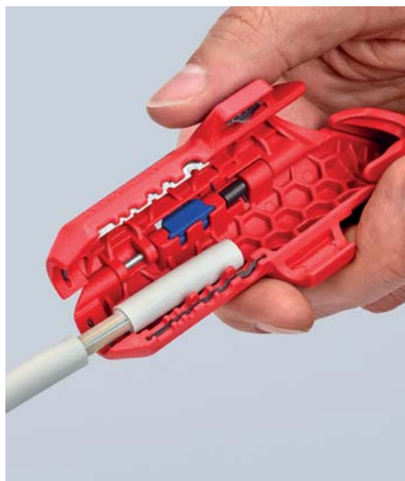
Odizolování kabelu NYM
