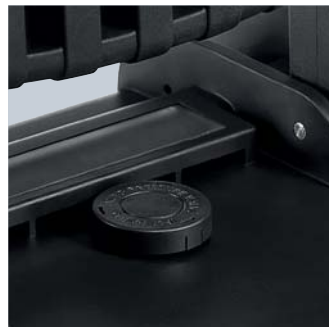
Automatický tlakový kompenzační ventil, po dobu zadržení vody prodyšný
