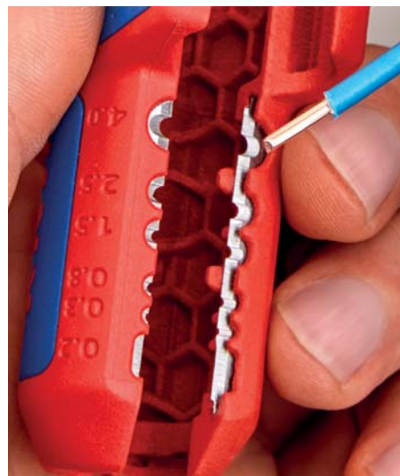
Odizolování jednotlivých vodičů
